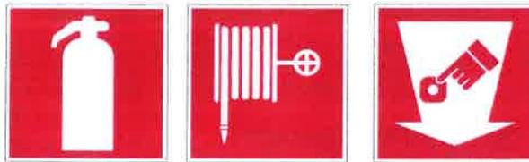
Les dimensions de ces panneaux doivent garantir une bonne visibilité. Ils seront installés à une hauteur et une position appropriée par rapport à l'angle de vue, compte tenu des obstacles et à des endroits bien éclairés et visibles.
